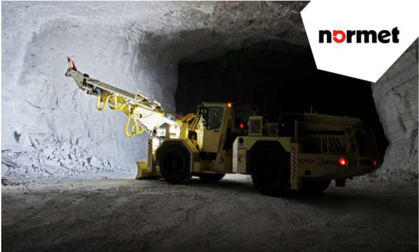
Рисунок 11 – Загальний вигляд оборзціка компаній НОРМЕТ на пневмоходу зі стрілою та гідромолотом на кінці
