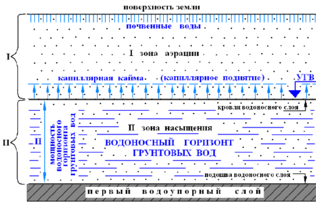
Рис.10 Схема залегания грунтовых вод (разрез)
