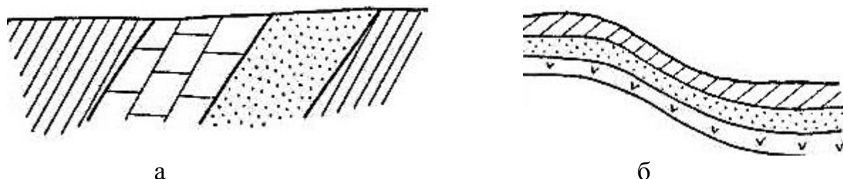
Рис.3. Простейшие пликативные нарушения: а – моноклинали; б – флексура
