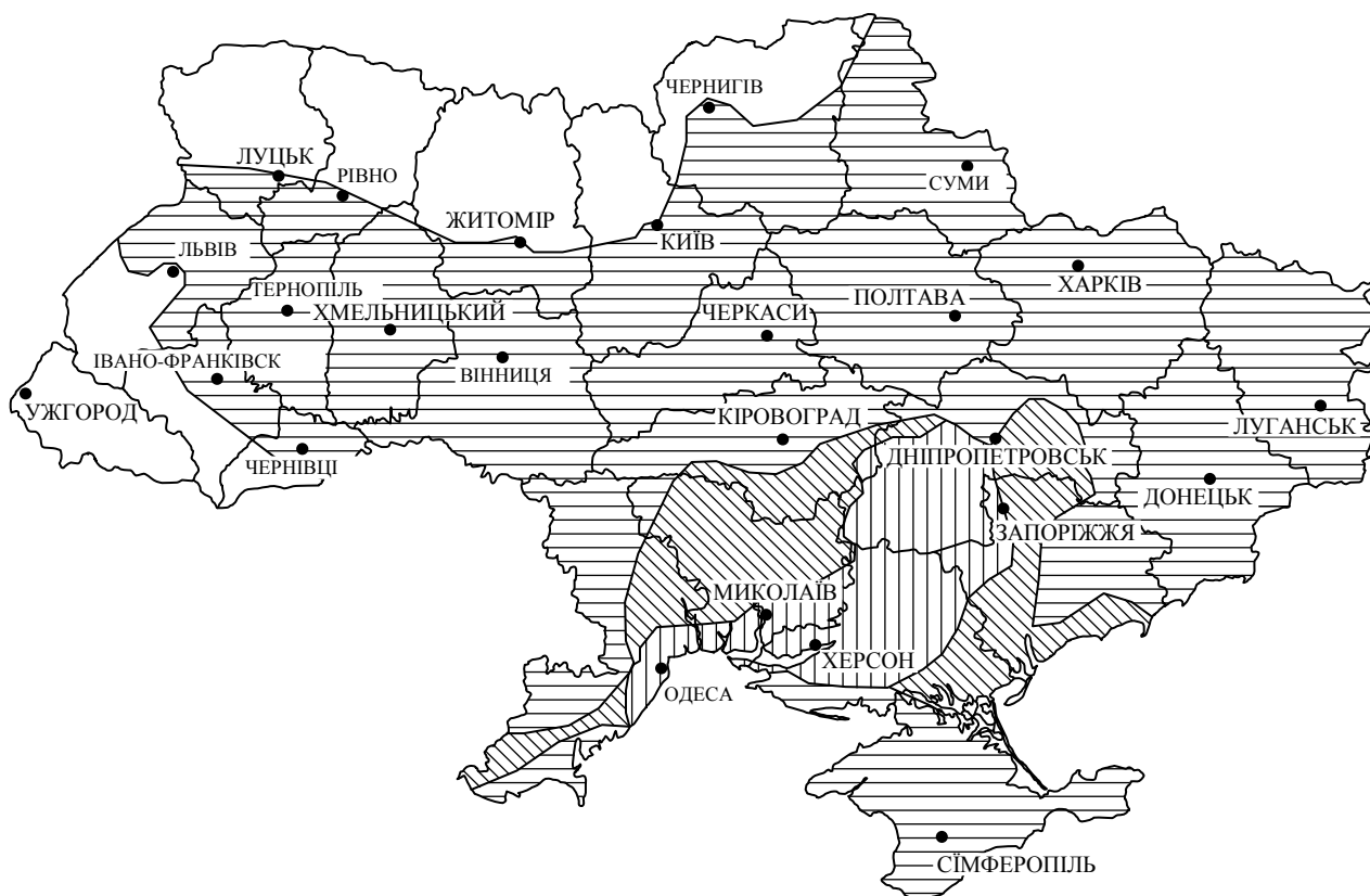
Рис. 1. – Схема розташування лесових ґрунтів (за Черним Г. І.)
